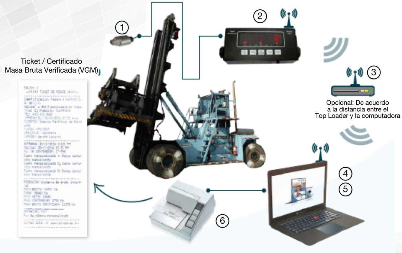
El transductor de presión se conecta al indicador de peso, inalámbricamente se transmite la información a la computadora con CoTBaC Contenedores, con la impresora conectada se imprime el Ticket de Masa Bruta Verificada (VGM)
